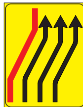
Fig. 411/e - 4117 segnale di corsie chiuse
