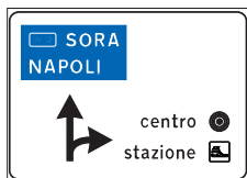
Fig. 233 segnale di preavviso di intersezione urbana
