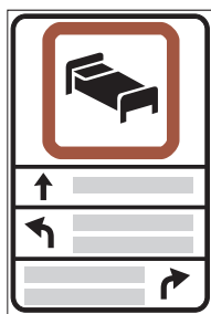
Fig. 300 segnale di preavviso alberghiere
