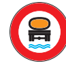
Fig. 64/b - 0642 transito vietato ai veicoli che trasportano prod. suscettibili di contaminare l'acqua
