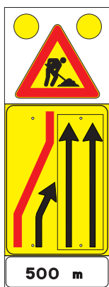
Fig. 399/a presegnale di cantiere mobile
