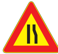
Fig. 386 - 3860 strettoia asimmetrica a destra
