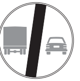
Fig. 73 - 0730 fine divieto sorpasso per veicoli di massa a pieno carico sup. 3,5 ton
